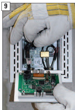
9 Steckverbindung mit der LUC-Displayeinheit verbinden.
