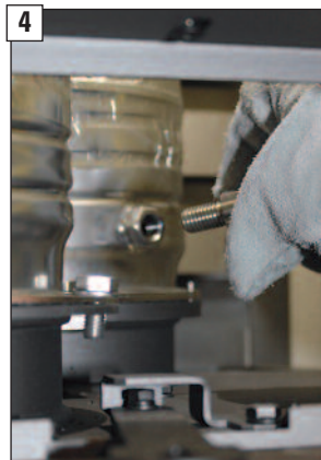
4 ... und entfernen. Die Edelstahlverschluss- schraube wird zur weite- ren Montage nicht mehr benötigt.
