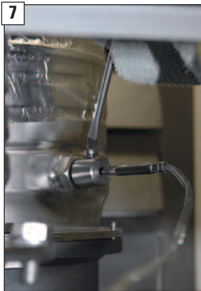
7 Temperatursensor (A) mit der Sicherungs- schraube gegen Heraus- rutschen fixieren.
