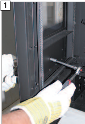
1 Werkseitig montierten Türgriff D abschrauben.
