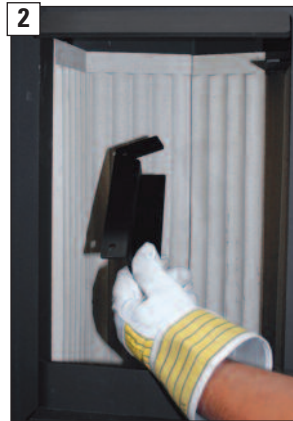
2 ... linken Haltewinkel für Prallplatte auf der Oberseite der Seitenkeramikverkleidung der Brennkammer aufstecken.
