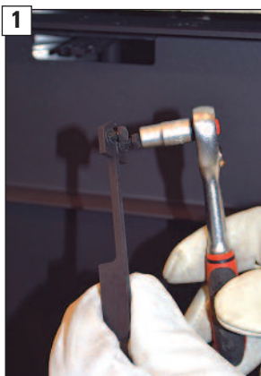
1 Befestigungsschrauben zur Montage soweit als möglich heraus-schrauben.
