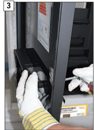
3 Verkürzten Türgriff B mit den vorhandenen Befestigungsteilen E und F montieren.
